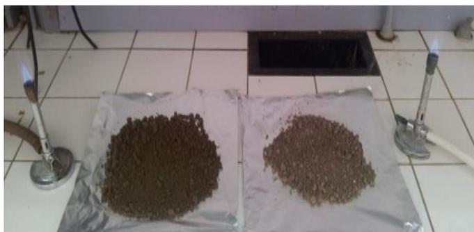
**Figure 7 : Séchage du sol à température ambiante**
