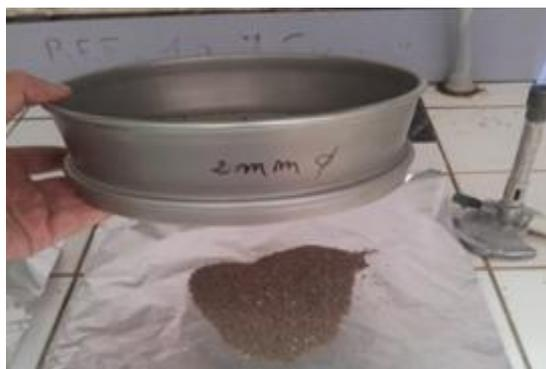
Figure 8 : Tamisage à 2 mm du sol sans engrais (Ferme 1)
