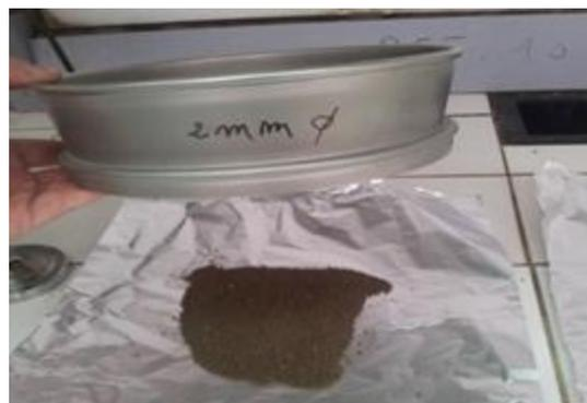
Figure 9 : Tamisage du sol à 2 mm avec engrais (Ferme 2)
